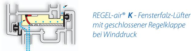
*REGEL-air® K - Fensterfalz-Lüfter mit geschlossener Regelklappe bei Winddruck*
